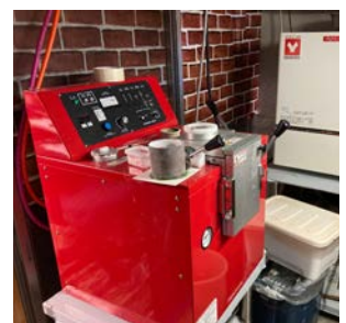
設計した指輪を製造する装置
